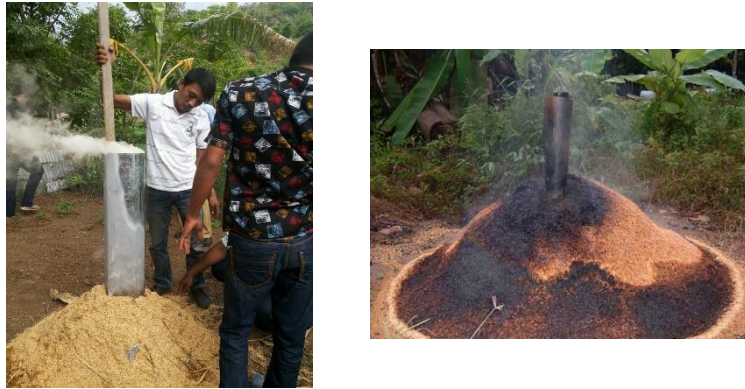
Gambar 4. Proses pembakaran sekam padi menjadi arang sekam
