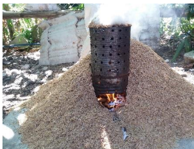
Gambar 3. Pembuatan alat pembakaran sekam padi
