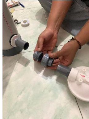
Gambar 5. Perakitan Pipa dengan Saringan air
