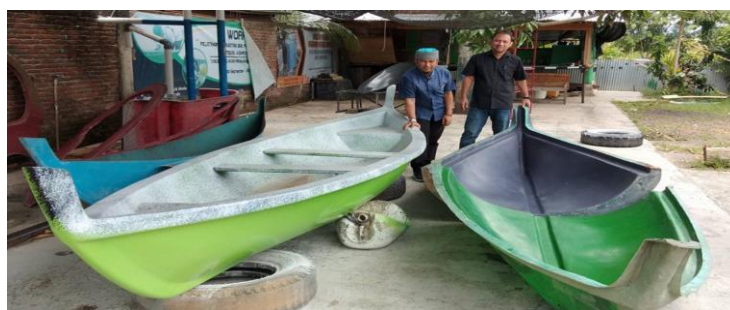
Gambar 4. Manufaktur Perahu Berbahan komposit sandwich Ramie – E-glass
