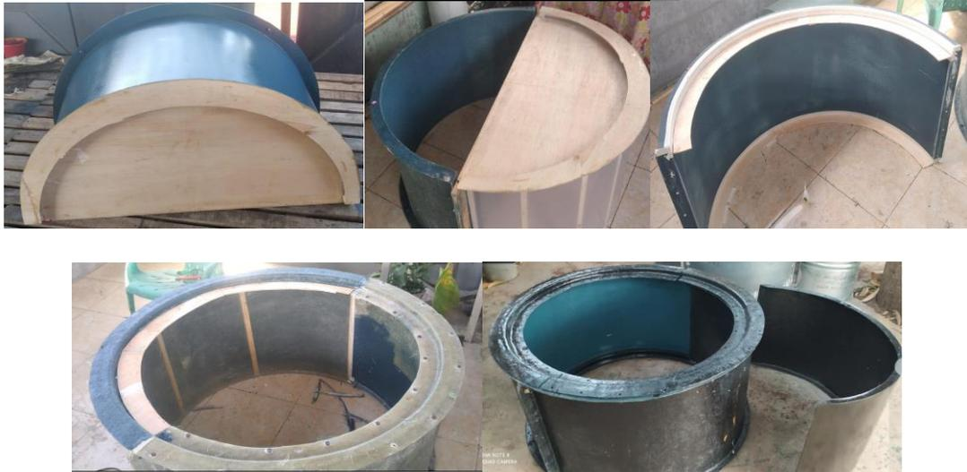
Gambar 2. Proses Tahapan Pembuatan Cetakan Cincin Sumur Berbahan Komposit
