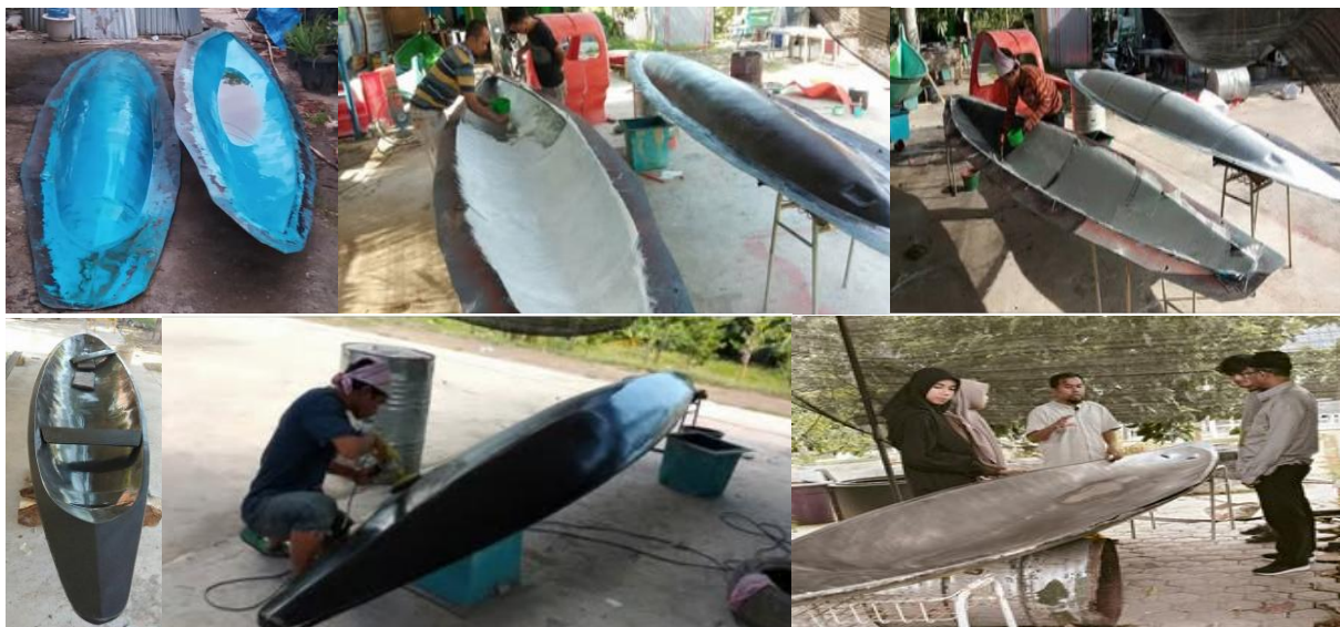
Gambar 4. Tahapan pembuatan cetakan hingga jadi produk jadi sebelum di finishing
