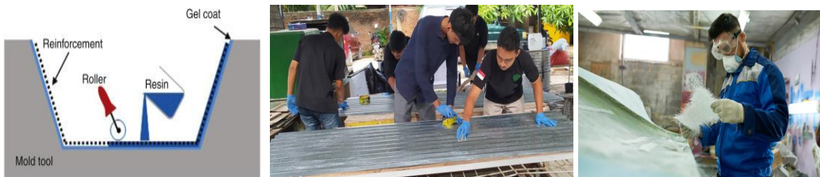
Gambar 4. Proses pencampuran resin dan laminasi serat kaca pada pembuatan seng fiber komposit
